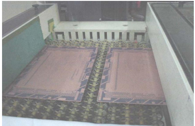
已完成显影段的内层芯板
